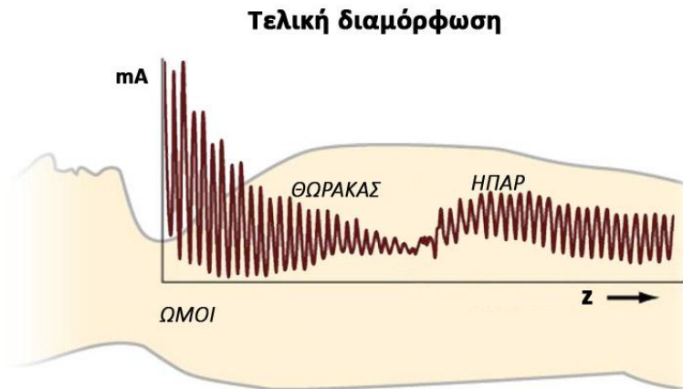
Εικόνα 15. Τελική αυτόματη διαμόρφωση των mA
