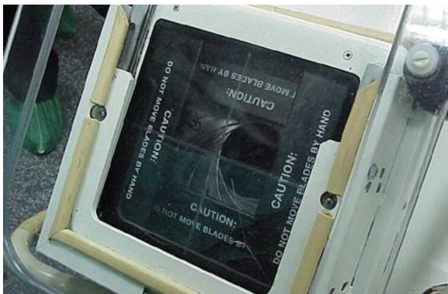
Εικόνα 21. Συνδυασμός επίπεδων διαφραγμάτων και διαφράγματος σε μορφή ίριδας
