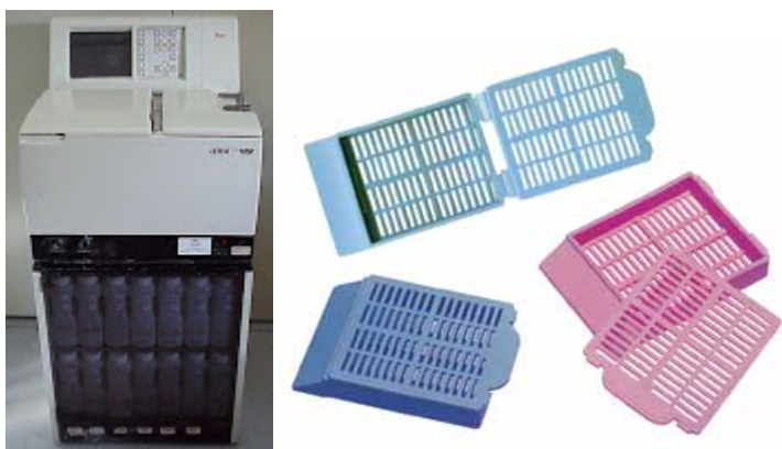
Εικ. 15 Αριστερά μηχανήμα ιστοκινέτας και δεξιά καψίδια μέσα στα οποία τοποθετούνται τα ιστοτεμάχια [http://www.biopsies.gr/2010/09/blog-post_04.html]
