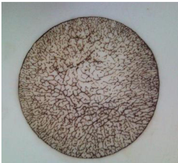
Εικόνα 53 Τελικό αποτέλεσμα της υλικογραφικής επεξεργασίας μιας πλήρους διατομής μηριαίας κεφαλής
