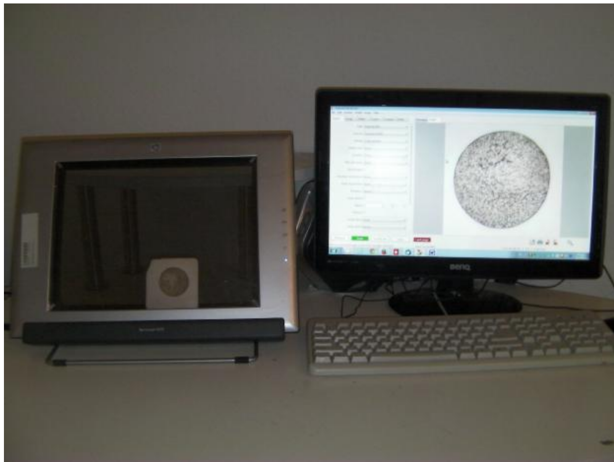
Εικόνα 54 Στιγμιότυπο της διαδικασίας ψηφιοποίησης ενός δείγματος σε επιτραπέζιο σαρωτή τύπου see-through vertical scanner HP ScanJet 4670. Για την ψηφιοποίηση μπορεί να χρησιμοποιηθεί ένας οποιοσδήποτε σύγχρονος σαρωτής που υποστηρίζει ανάλυση τουλάχιστον 4800DPI.
