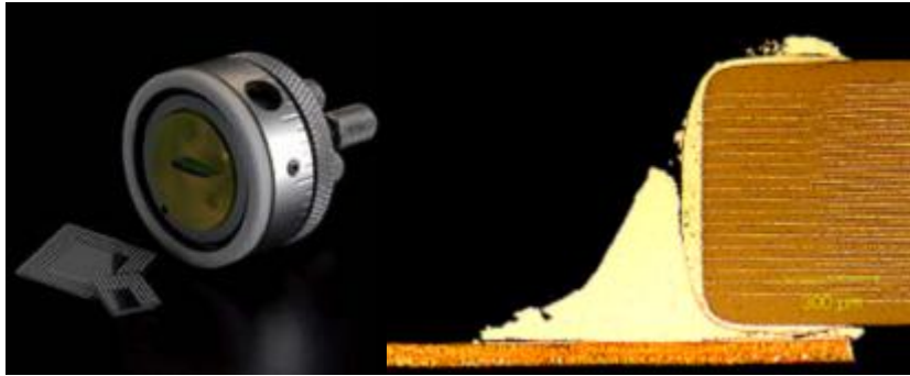
Εικόνα 7 Παράδειγμα υλικογραφικής μελέτης μιας ελαττωματικής παρτίδας μικροηλεκτρονικών chip (πλαστικογραφία), όπου αναδεικνύεται η ύπαρξη μικροσκοπικών ρωγμών στις αγωγίμες συνδέσεις μεταξύ των χάλκινων στοιχείων.
