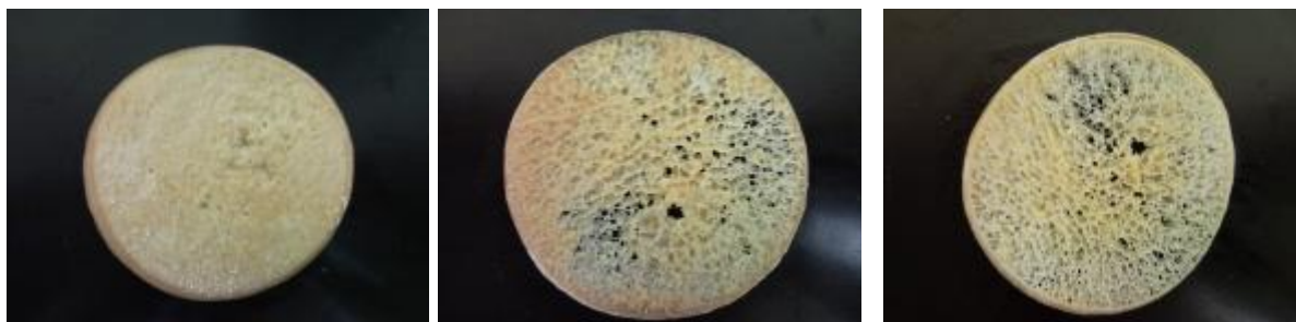
Εικόνα 35 Πρόοδος της αφαίρεσης του λίπους από τις οστικές κυψέλες ανά 30sec. Τα δείγματα θα πρέπει να ελέγχονται οπτικά ώστε να μη διακινδυνεύει η ακεραιότητα των οστεοδοκίδων..
