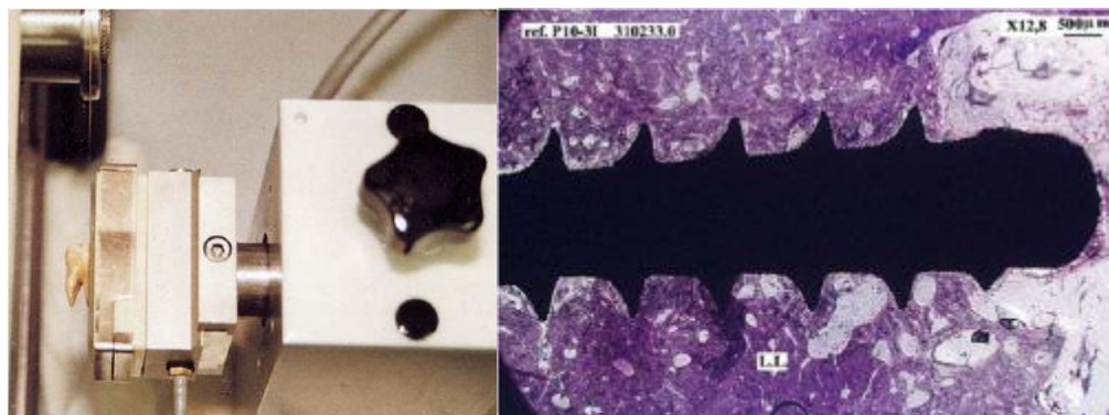
Εικόνα 14 Υβριδικό μηχανήμα κοπής ακριβείας και λείανσης. Χρώση οστικού δείγματος με εμφύτευμα in situ κυανό τολουιδίνης προς οπτική μικροσκόπηση (από Alava et al, 2005 8 )
