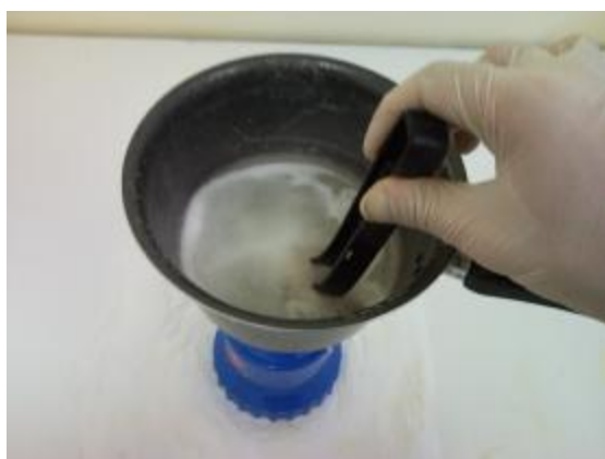
Εικόνα 36 Το δείγμα καθιλώνεται με πλαστικό αντικείμενο στον πυθμένα του βραστήρα, όπου η ένταση του βρασμού είναι μεγαλύτερη.
