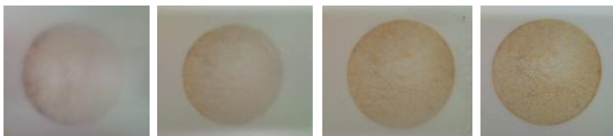
Εικόνα 48 Σταδιακή ανάδυση του εγκιβωτισμένου οστού στην επιφάνεια κατά τη λείανση με αδρό κόκκο 80.
