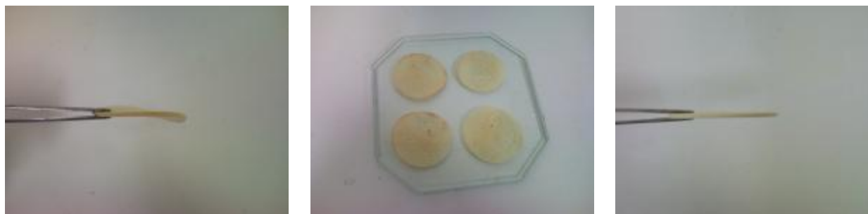
Εικόνα 37 Μετά την επεξεργασία καθαρισμού τα δείγματα συνήθως παραμορφώνονται. Προκειμένου να επιπεδωθούν, αφήνονται να στεγνώσουν ανάμεσα σε δύο υαλοπίνακες με βάρος (δεν απεικονίζεται).
