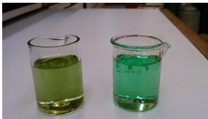
Εικόνα 29. Διαλύματα των συμπλόκων [W\{S_2C_2(C_6H_5)_2\}_3](TBA) (καφέ-πράσινο) και [W\{S_2C_2(C_6H_5)_2\}_3] (γαλάζιο-πράσινο).
