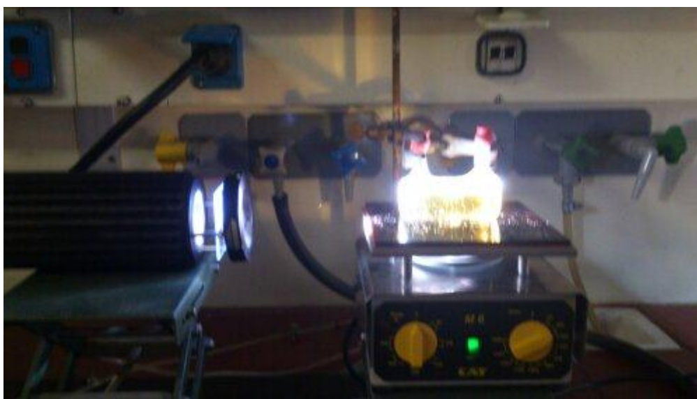
Εικόνα 30. Πειραματική διάταξη συστήματος [Ni-2MeO^1-] (4) / [ReBr (CO)_3bpy] / TEOA/ AcOH σε DMF.
