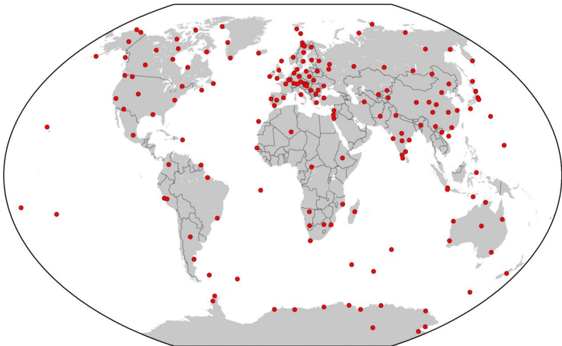
Εικόνα 1.21 Παγκόσμιος χάρτης με τις κουκίδες να σηματοδοτούν τις τοποθεσίες όπου υπάρχουν γεωμαγνητικά παρατηρητήρια
