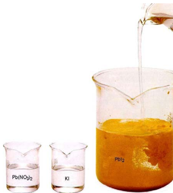
ΣΧΗΜΑ 3.3 Εικονική παρουσίαση της αντίδρασης διπλής αντικατάστασης μεταξύ \text{Pb}(\text{NO}_3)_2 και \text{KI} προς σχηματισμό του κίτρινου ιζήματος \text{PbI}_2 .
