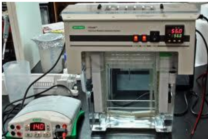
Εικόνα 1.8 Ηλεκτροφόρηση σε πήκτωμα ακρυλαμίδης παρουσία αποδιατακτικού παράγοντα (DGGE)
