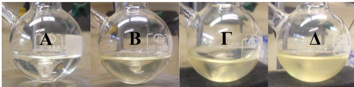
Εικόνα 3.5: Πορεία του πολυμερισμού της PtBMLC με απαρχητή DMA μετά από (Α) 1 ημέρα, (Β) 2 ημέρες, (Γ) 3 ημέρες και (Δ) 5 ημέρες αντίστοιχα
