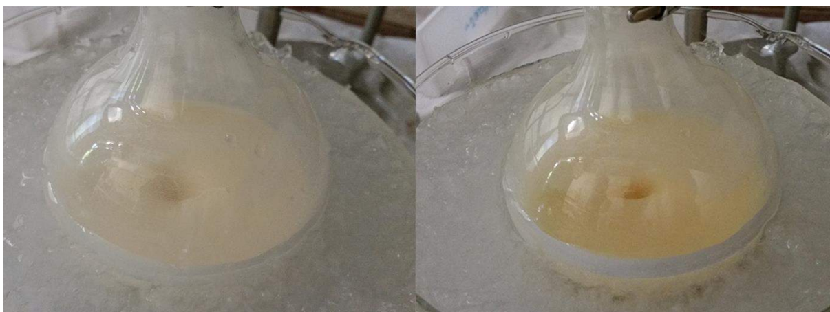
Εικόνα 3.2: Διάλυμα υδροχλωρικού άλατος του N_{(im)}\text{-Trt-His NCA} πριν (αριστερά) και μετά (δεξιά) την προσθήκη του διαλύματος της \text{Et}_3\text{N}
