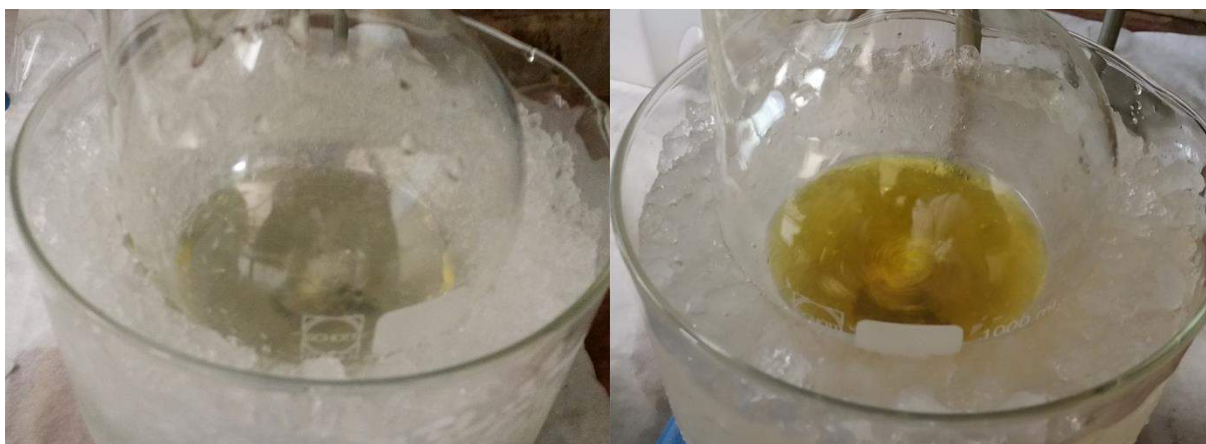
Εικόνα 3.1: Διάλυμα της BOC-His(Trt)-OH σε THF πριν την προσθήκη του \text{SOCl}_2 (αριστερά) και μετά από 2.5 ώρες αντίδρασης με \text{SOCl}_2 (δεξιά)
