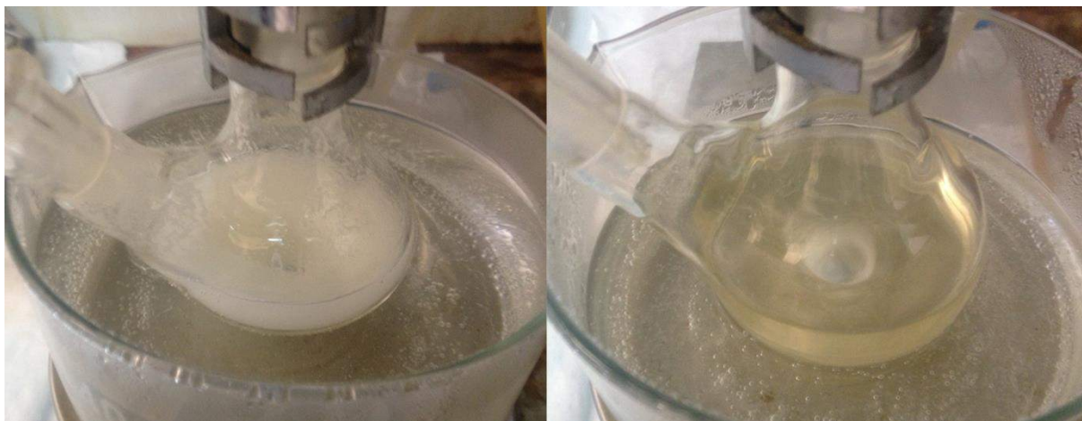
Εικόνα 3.3: Διάλυμα της H-Cys(StBu)-OH σε EtOAc πριν την προσθήκη τριφωσγενίου (αριστερά) και μετά από δύο ώρες αντίδρασης προς σχηματισμό του tBMLC NCA (δεξιά)
