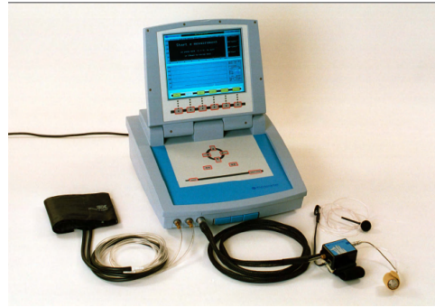
Εικόνα 2.1. Η φωτοπληθυσμογραφική συσκευή Finometer. Διακρίνεται η κεντρική μονάδα και τα περιφερειακά εξαρτήματα (Ανατύπωση από TNO Finger Pressure Reference Guide).
