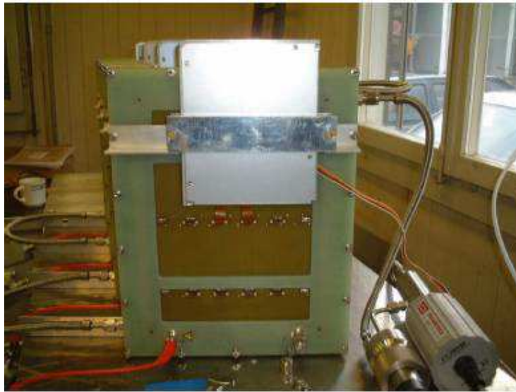
Εικόνα 2.3.2.2 Οπίσθιο τμήμα της μονάδας TRD χωρίς ακτινοβολητή
