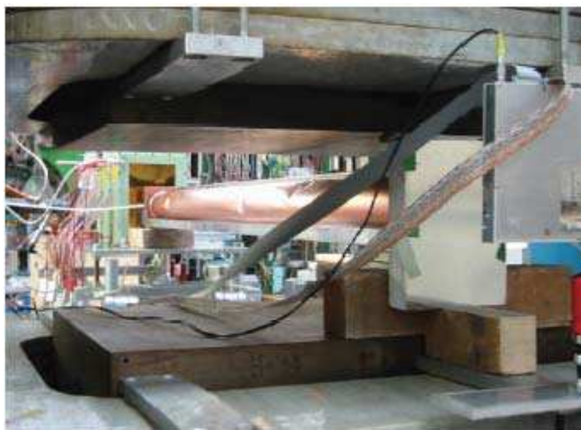
Εικόνα 3.2.2 εικόνα εγκατάστασης, μαγνήτης, σωλήνα ηλίου, ακτινοβολητής, DC και SD
