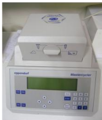
Εικόνα 31. Θερμοκυκλοποιητής Mastercycler (Eppendorf, Hamburg, Germany).
