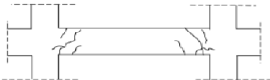
Εικόνα 4.29: Διατμητική αστοχία δοκού (Πηγή: Δρίτσος 2005)
