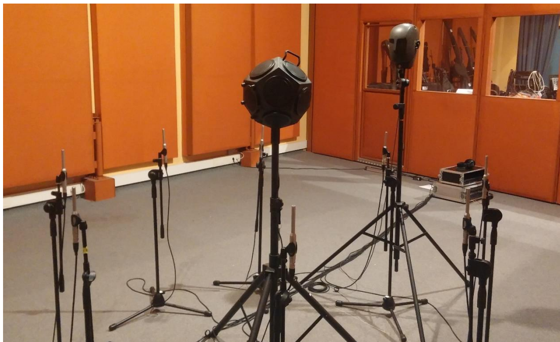
Εικόνα 14 – Η αίθουσα κατά την εκτέλεση των μετρήσεων για την ισοστάθμιση του κέρδους των προενισχυτών. Τα οκτώ μικρόφωνα είναι διατεταγμένα σε κύκλο ακτίνας ενός μέτρου γύρω από την πηγή.
