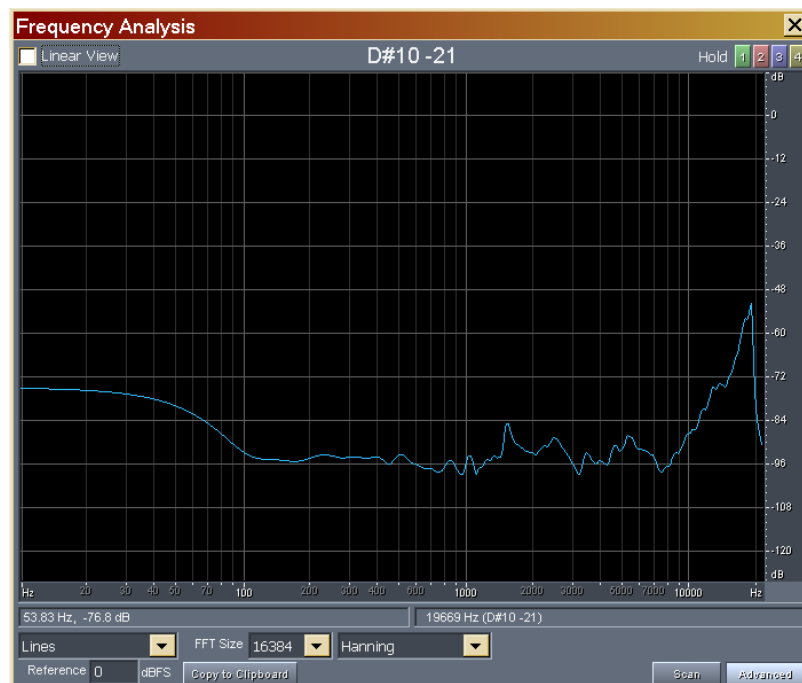
Εικόνα 30 – Καμπύλη φάσματος του φίλτρου εξισορρόπησης φάσματος [3]
