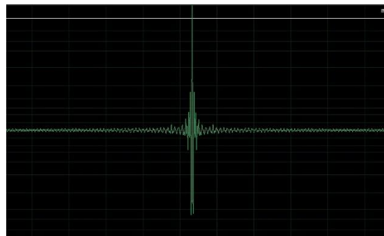
Εικόνα 36 – Το φίλτρο εξισορρόπησης του φάσματος ως κρουστική απόκριση
