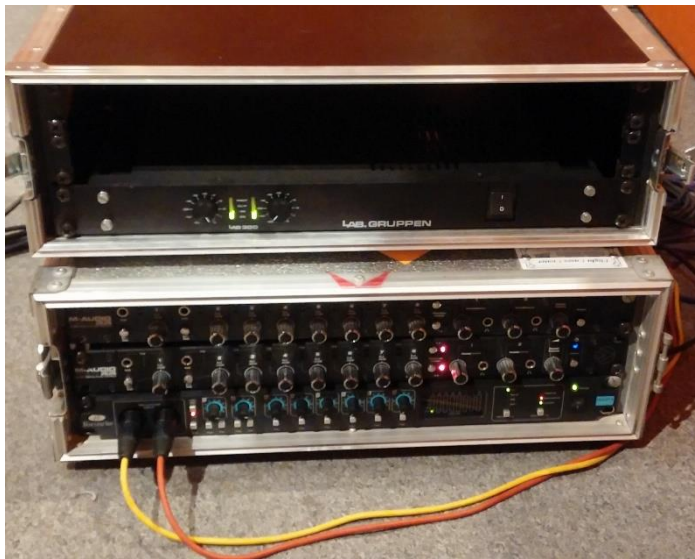
Εικόνα 13 – Εξοπλισμός ακουστικών μετρήσεων. Επάνω: ο τελικός ενισχυτής του πανκατευθυντικού μεγάφωνου Bruel & Kjaer 4296. Κάτω: οι κάρτες ήχου που χρησιμοποιήθηκαν κατά τις ακουστικές μετρήσεις.
