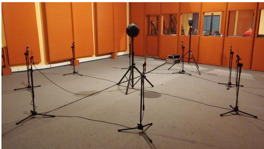
Εικόνα 15 – Η αίθουσα κατά την διεξαγωγή των ακουστικών μετρήσεων, με τα μικρόφωνα διατεταγμένα γύρω από την πηγή σε κύκλο ακτίνας 2,5m
