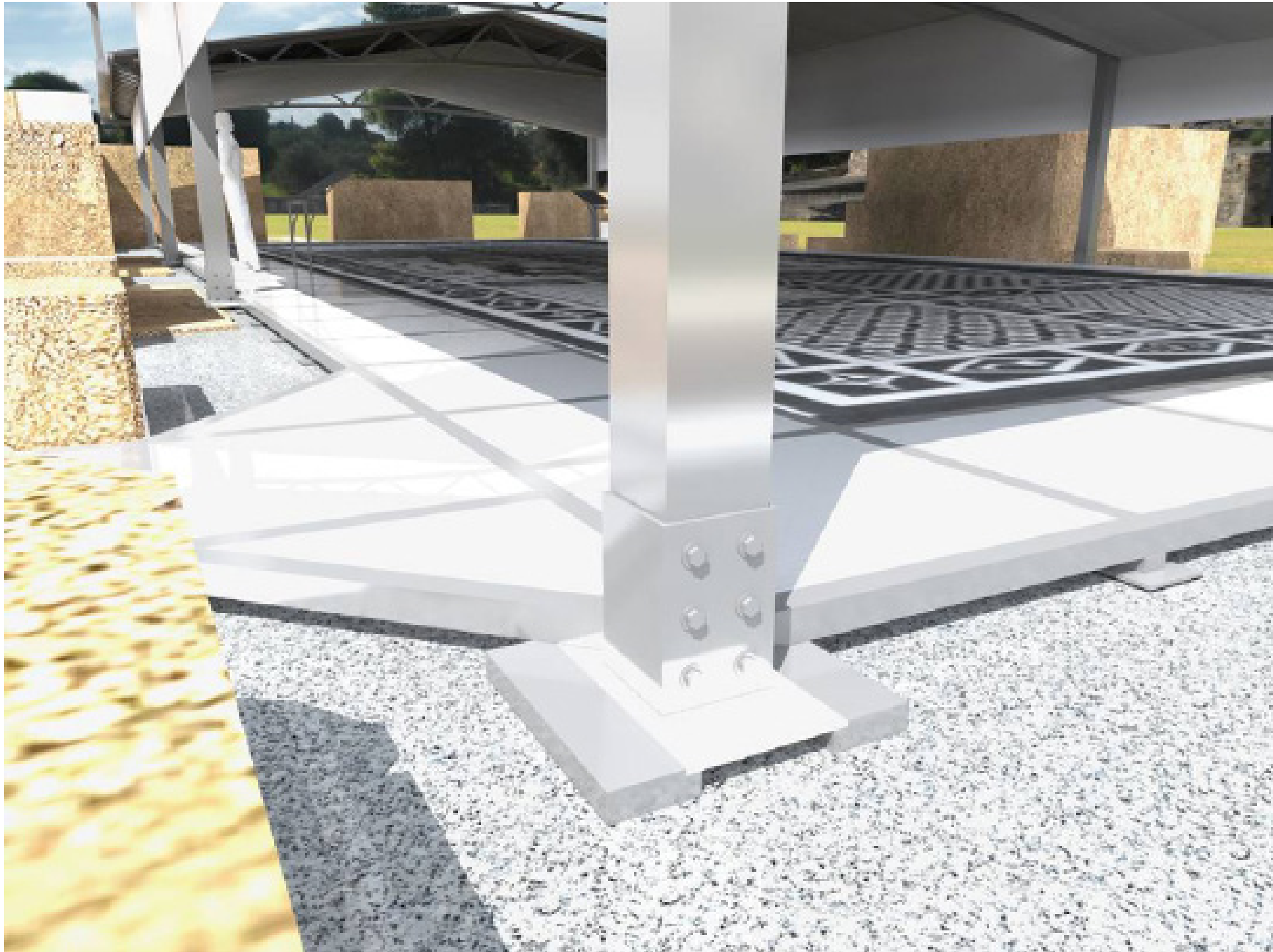
Εικόνα 5: Τα δικτυώματα είναι αρθρωμένα σε κομβοελάσματα πάνω σε οριζόντιες κοιλοδοκούς, που είναι τοποθετημένες στην περίμετρο του εσωτερικού χώρου. Οι κοιλοδοκοί αποτελούν ένα είδος επιφανειακής θεμελίωσης της κατασκευής του στεγάστρου η οποία χρησιμεύει και ως διάδρομος περιήγησης των επισκεπτών.
