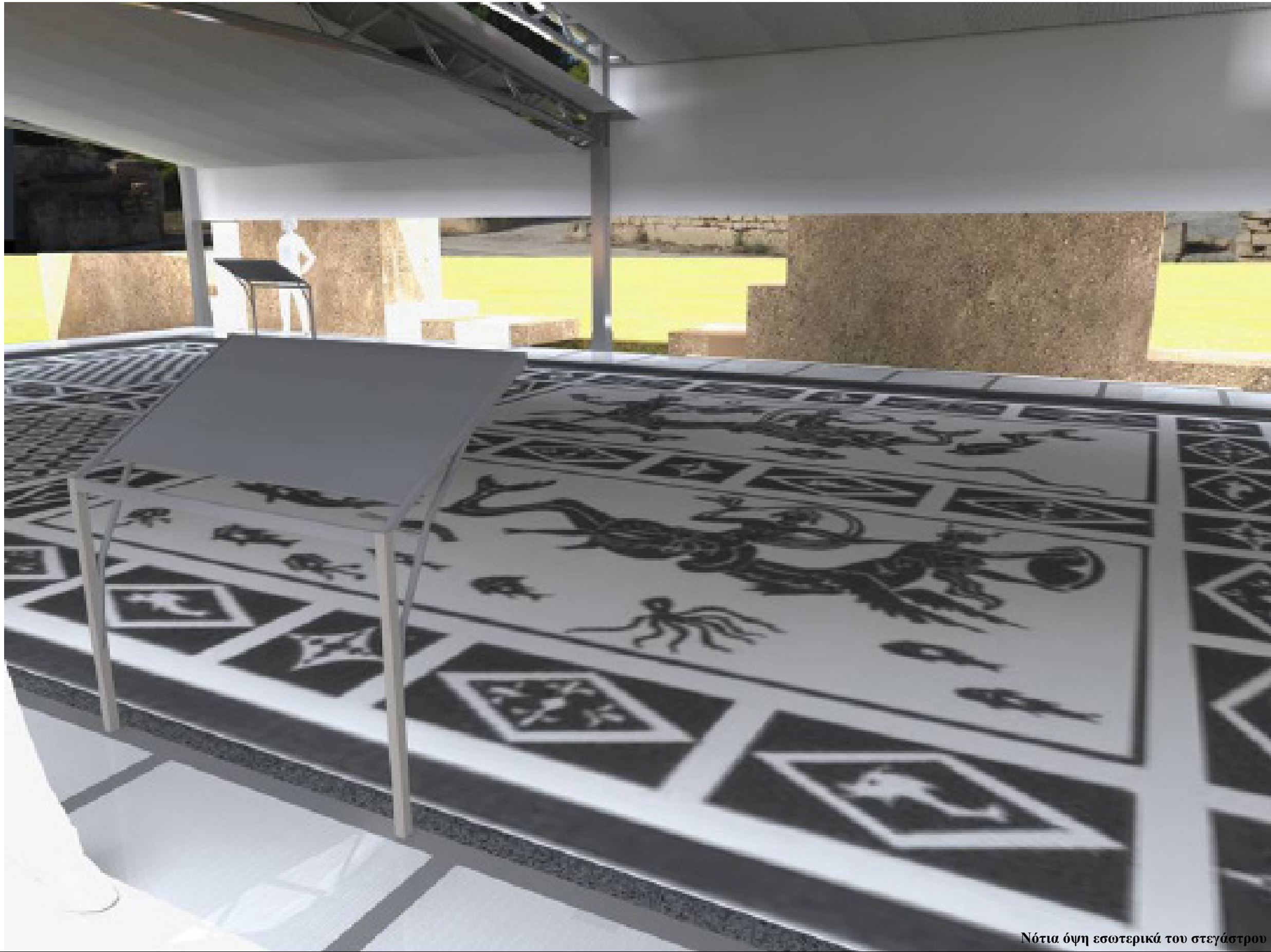
Εικόνα 7: Εξωτερικά ο μεταλλικός φορέας, καλύπτεται με εφελκόμενη μεμβράνη, υπόλευκης απόχρωσης ενώ εσωτερικά η οροφή είναι καλυμμένη με ελαφρού τύπου, λεπτό ανοξείδωτο πλέγμα πυκνής ύφανσης, αποσπώντας μέρος της θέασης των δικτυωμάτων και της εφελκόμενης μεμβράνης. Η κάλυψη αυτή ταυτόχρονα με τους αισθητικούς λόγους καλύπτει και λειτουργικούς καθώς εξυπηρετεί στην αποφυγή φθοράς και της αισθητικής «βλάβης» που προκαλούν τα περιττώματα των πτηνών.
