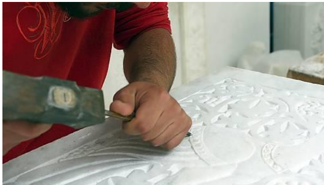
Εικόνα 12 - Σμιλεύοντας μάρμαρο για τη δημιουργία υπέρθυρου.
