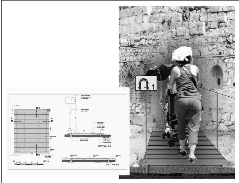
Fig. 11. La passerelle en bois et sa structure métallique (plan et coupes).
