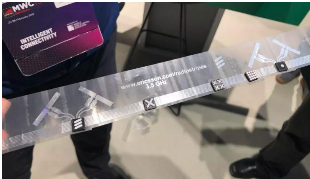
Σχήμα 6-4: Πρωτοποριακό radio stripe από πλαστικό της εταιρίας Ericsson [97].
