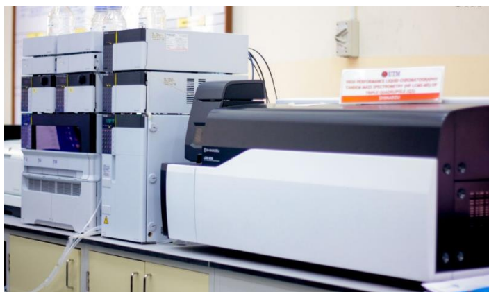
Εικόνα 6: Σύγχρονος Υγροχρωματογράφος υψηλής απόδοσης Shimadzu HPLC-MS/MSQ 3 60
