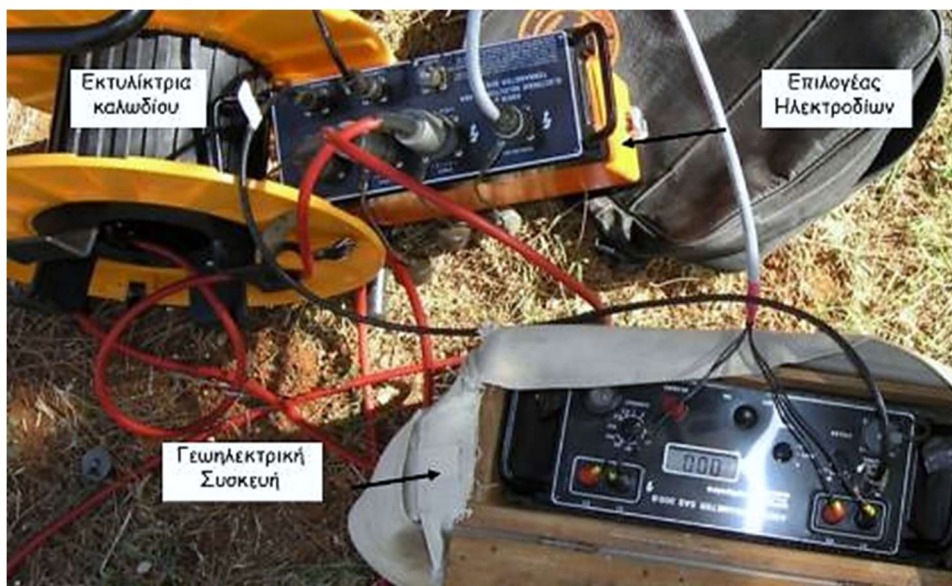
Εικ. 2.8: Εξοπλισμός υπαίθρου για την πραγματοποίηση της τεχνικής της γεωηλεκτρικής τομογραφίας.
