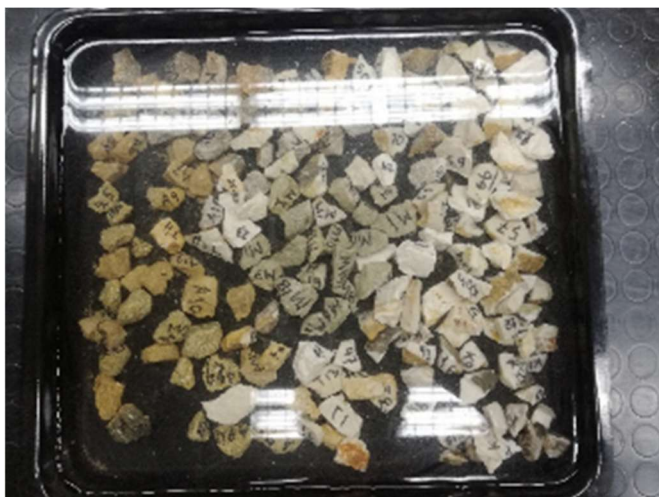
Εικ. 3.50: Βύθιση των διαμορφομένων δειγμάτων στο νερό για διάστημα δύο ημερών για τον πλήρη κορεσμό τους.
