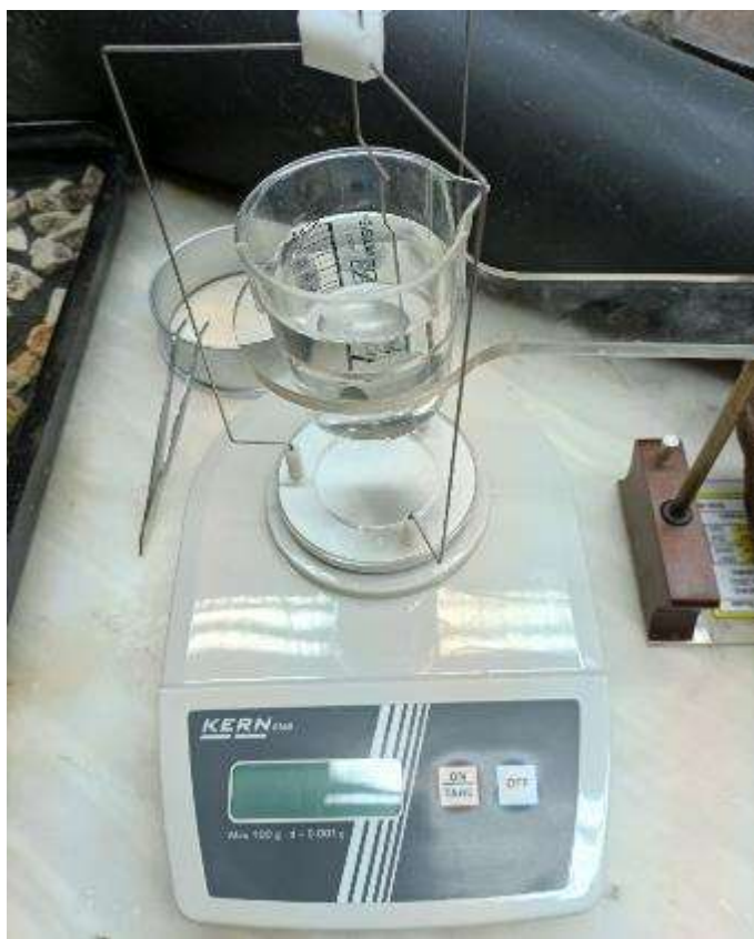
Εικ. 3.51: Η πειραματική διάταξη για τον προσδιορισμό του κορεσμένου βάρους. Η βάση των δειγμάτων είναι εμποτισμένη σε σταθερό βάθος εντός δοχείου που εμπεριέχει απιονισμένο νερό με σκοπό τη βύθιση ολόκληρου του δείγματος εντός του υγρού. Η διάταξη τοποθετείται με ειδικά σχεδιασμένη βάση πάνω σε ζυγό ακριβείας για τη μέτρηση του βάρους.
