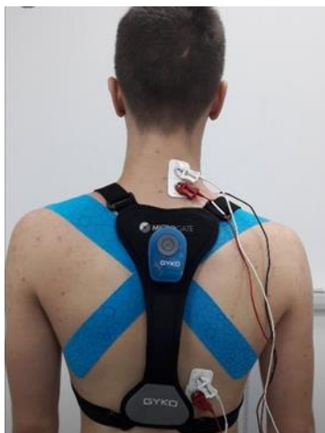
Εικόνα 2. Αδρανειακός αισθητήρας, ο οποίος χρησιμοποιήθηκε για την καταγραφή της ταλάντωσης του κορμού
