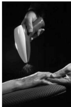
Εικόνα 8. Φορητή συσκευή ηλεκτροϊονποίησης για άμεση εφαρμογή στην επούλωση πληγών (Huang et al., 2003).
