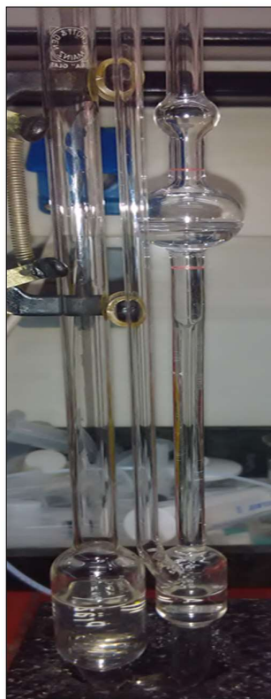
Εικόνα 31. Ιξωδόμετρο Ubbelohde για τον προσδιορισμό του κινηματικού ιξώδους.
