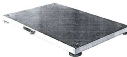
Εικόνα 3.1. Ηλεκτρονικό δυναμοδάπεδο Kistler 9286AA, Switzerland, με συχνότητα δειγματοληψίας 1000Hz.
