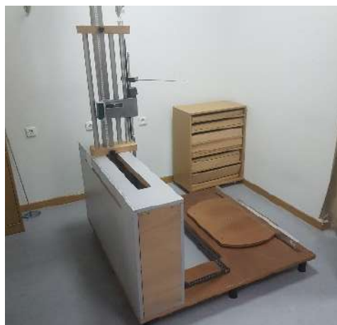
Εικόνα 3.4 Πρότυπη κατασκευή πλατφόρμας για την μέτρηση του προσανατολισμού της λεκάνης
