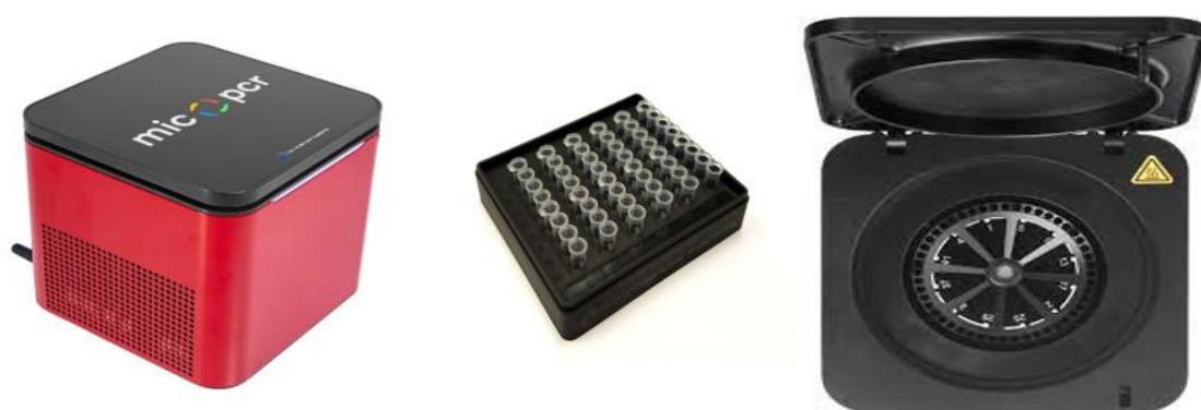
Σχήμα 3.17 Ο αναλυτής Mic Real-Time PCR System. Απεικονίζονται το όργανο, τα σωληνάρια, καθώς και οι 48 θέσεις τοποθέτησης των δειγμάτων στον περιστροφέα του οργάνου
