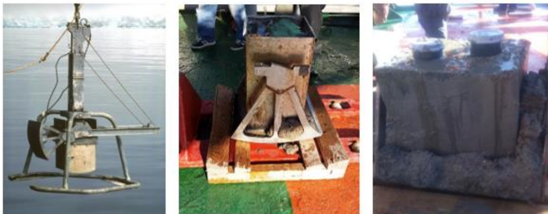
Εικόνα 12 . Box Corer: Διάφορα στάδια από τη συλλογή του δείγματος μέχρι το άνοιγμα του
