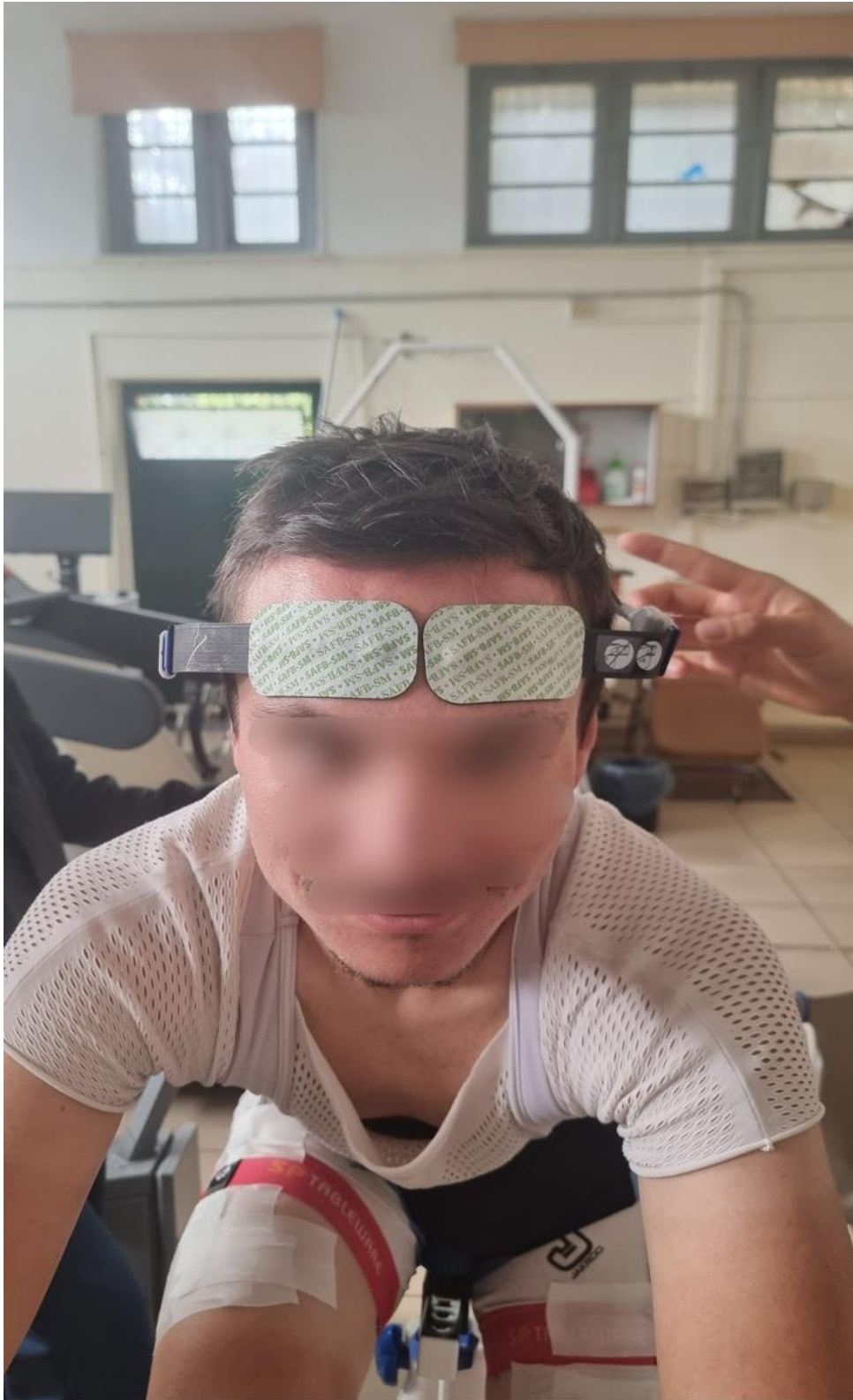
Εικόνα 3.3 Σε κάθε δοκιμαζόμενο τοποθετήθηκαν επίσης 2 ηλεκτρόδια της συσκευής innos αντίστοιχα με τους μετωπιαίους λοβούς
