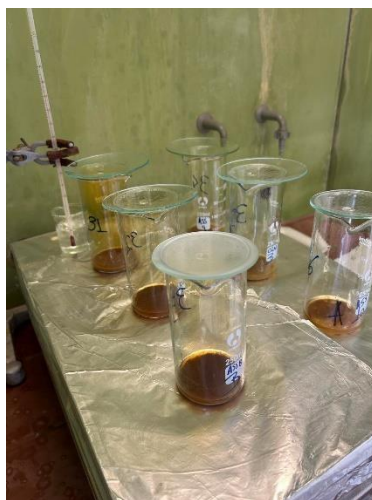
Εικόνα 3.7: Τα ποτήρια ζέσεως με τι ζυγισμένο ποτάμιο ίζημα και 10ml αραιού \text{HNO}_3 , καλυμμένα με υέλους ωρολογίου και τοποθετούνται στη θερμοτράπεζα της 85^\circ\text{C} \pm 5^\circ\text{C} .
