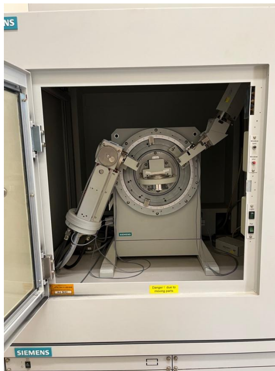
Εικόνα 2.10 & 2.11 Περιθλασίμετρο ακτίνων X (XR Diffractometer) Bruker (Siemens) D5005
