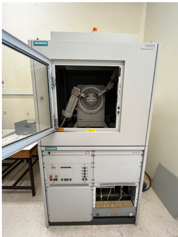
Εικόνα 2.10 & 2.11 Περιθλασίμετρο ακτίνων X (XR Diffractometer) Bruker (Siemens) D5005
