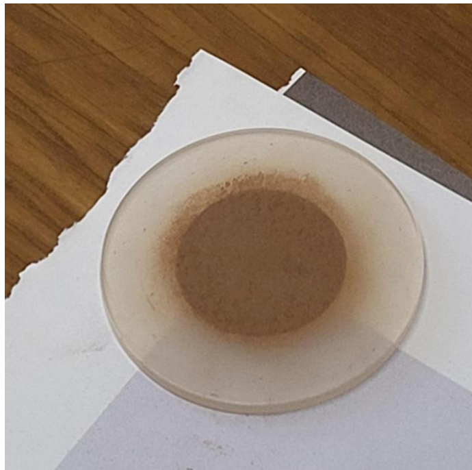
Εικόνα 2.9 Υποδοχέας δείγματος για XRD
