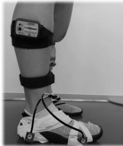
Εικόνα 3.3. Τοποθέτηση αισθητήρων κρούσεων και επιταχυνσιόμετρου.
