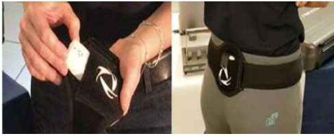
Εικόνα 3.7. Τοποθέτηση αδρανειακού αισθητήρα (BTS G-Walk) - Βήμα 3. Ο αισθητήρας τοποθετείται σε ειδική θήκη της ελαστικής ζώνης (G-walk user manual, 2016).
