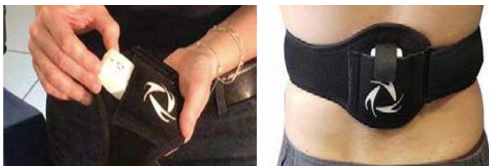
Εικόνα 3.10. Τοποθέτηση αδρανειακού αισθητήρα (BTS G-Walk) -Βήμα 3. Ο αισθητήρας τοποθετείται σε ειδική θήκη της ελαστικής ζώνης (G-walk user manual, 2016).
