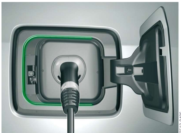
Εικόνα 38: Απεικόνιση πράσινου LED σε λειτουργία. Λήξη φόρτισης, Φόρτιση πλήρης. Πηγή: BMW AG
