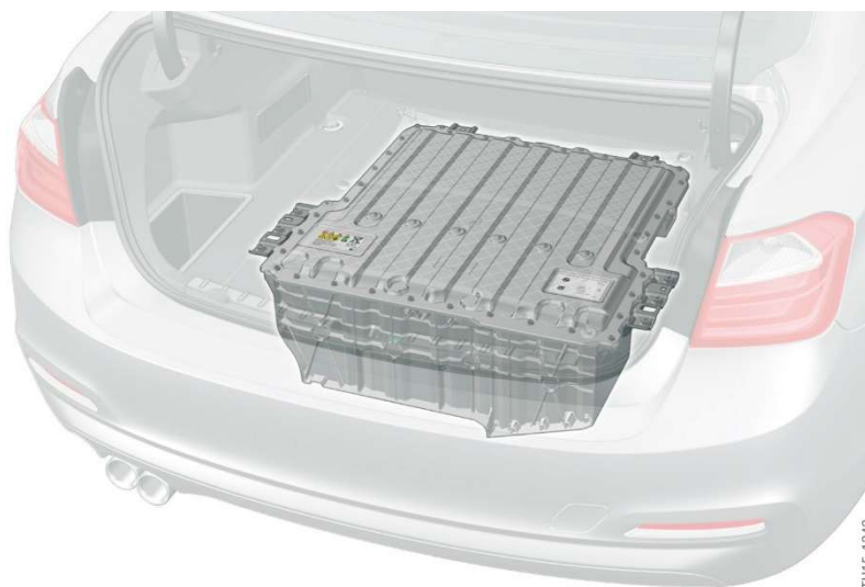
Εικόνα 14: Απεικόνιση μπαταρίας υψηλής τάσης κάτω από τον χώρο αποσκευών. Πηγή: BMW AG
