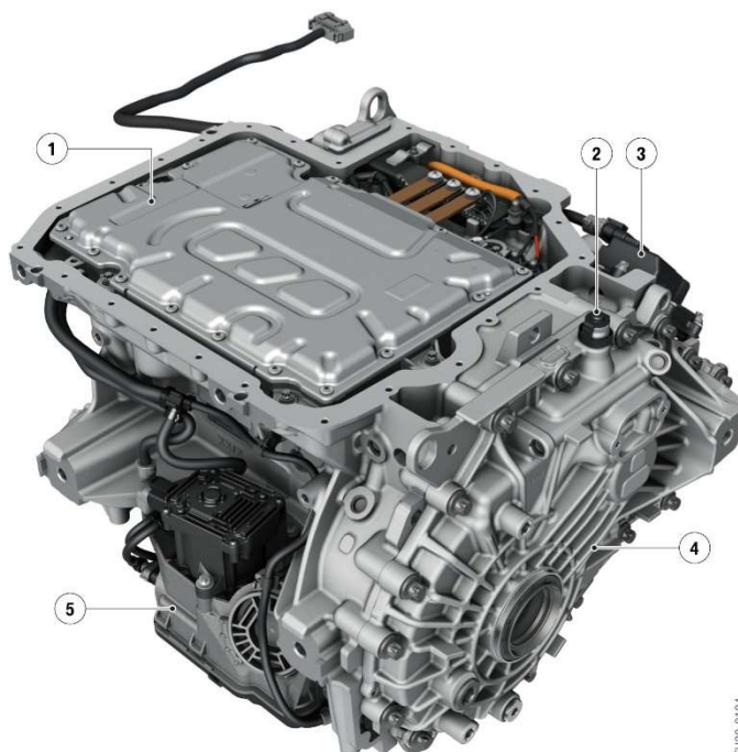
Εικόνα 55: 1) Ηλεκτρονικά ηλεκτροκινητήρα EME (απεικόνιση χωρίς καπάκι περιβλήματος), 2) Εξαερωτήρας, 3) Ηλεκτρική μονάδα μηχανισμού κλειδώματος κιβωτίου ταχυτήτων, 4) Μηχανικό κιβώτιο ταχυτήτων (μίας βαθμίδας) με διαφορικό, 5) Μονάδα λαδιού. Πηγή: BMW AG
