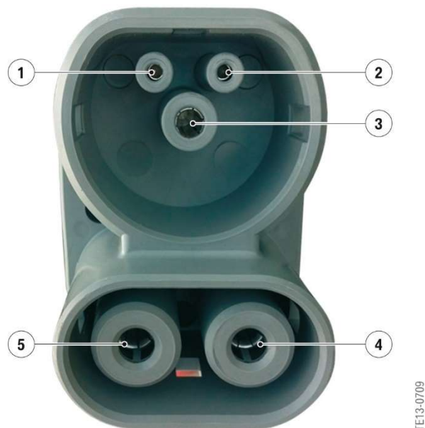
Εικόνα 42: 1) Σύνδεση για φάση L1, 2) Σύνδεση για καλώδιο αναγνώρισης φως φόρτισης, 3) Σύνδεση για αγωγό γείωσης ασφαλείας PE, 4) Σύνδεση για καλώδιο Pilot, 5) Σύνδεση για ουδέτερο αγωγό N, 6)
