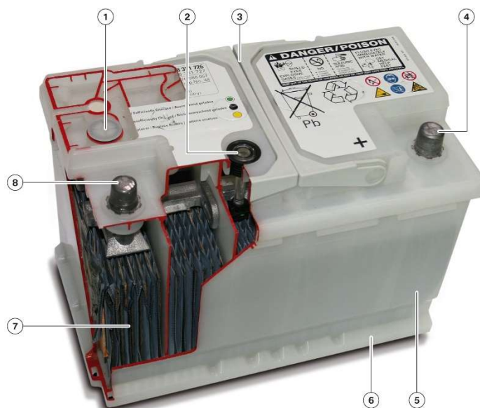
Εικόνα 5: 1) Κάλυμμα σφράγισης, 2) Υδρόμετρο, 3) Λαβή μεταφοράς, 4) Θετικός πόλος της μπαταρίας, 5) Περίβλημα μπαταρίας, 6) Λωρίδα κάτω πλευράς για τη στερέωση της μπαταρίας, 7) Λωρίδα κάτω πλευράς για τη στερέωση της μπαταρίας, 8) Αρνητικός πόλος της μπαταρίας. Πηγή: Bosch GmbH
