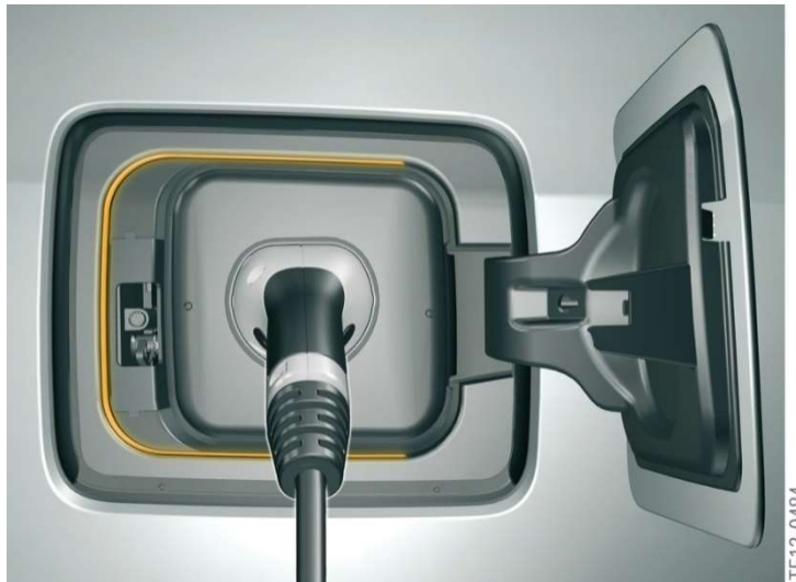
Εικόνα 36: Απεικόνιση πορτοκαλί LED σε λειτουργία. Διαδικασία σωστής σύνδεσης φης φόρτισης. Πηγή: BMW AG
