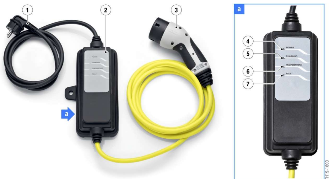
Εικόνα 47: 1) Ρευματολήπτης, 2) In-Cable-Control-Box (ICCB), 3) Φις φόρτισης, 4) Ένδειξη LED (πράσινο) για τη διαθεσιμότητα της τροφοδοσίας ρεύματος, 5) Ένδειξη LED (μπλε) για τη φόρτιση, 6) Ένδειξη LED (κίτρινο) για υπερβολικά υψηλές θερμοκρασίες, 7) Ένδειξη LED (κόκκινο) για σφάλμα κατά τη φόρτιση. Πηγή: BMW AG
