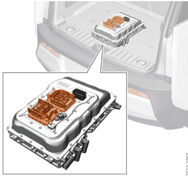
Εικόνα 68: Μετατροπέας διπλής κατεύθυνσης DC/AC, που μπορεί να λειτουργήσει και ως μετατροπέας και ως ανορθωτής. Πηγή: BMW AG
