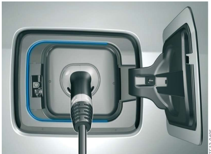
Εικόνα 37: Απεικόνιση μπλε LED σε λειτουργία. Διαδικασία φόρτισης σε εξέλιξη. Πηγή: BMW AG
