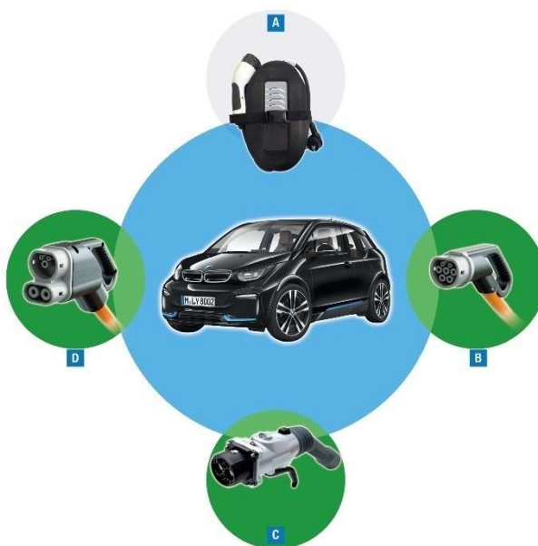
Εικόνα 28: A) Φόρτιση εναλλασσόμενου ρεύματος στάνταρ 2,4kw, B) Φόρτιση εναλλασσόμενου ρεύματος μονοφασική ή πολυφασική 3,7-11kw, C) Φόρτιση με συνεχές ρεύμα CHAdeMO 50kw Ιαπωνία, D) Φόρτιση με συνεχές ρεύμα COMBO 50kw (Ταχυφόρτιση). Πηγή: BMW AG
