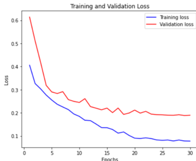
Figure 22: Η πορεία της μετρικής της απώλειας κατά τη διάρκεια των 30 εποχών. Παρατηρείται συνεχής μείωση και σταθεροποίηση στην 24 η εποχή και για τα δύο σετ δεδομένων.
