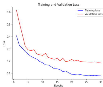
Figure 55: Η πορεία της μετρικής της απώλειας κατά τη διάρκεια των 30 εποχών. Παρατηρείται συνεχής μείωση και σταθεροποίηση στην 24 η εποχή και για τα δύο σετ δεδομένων.
