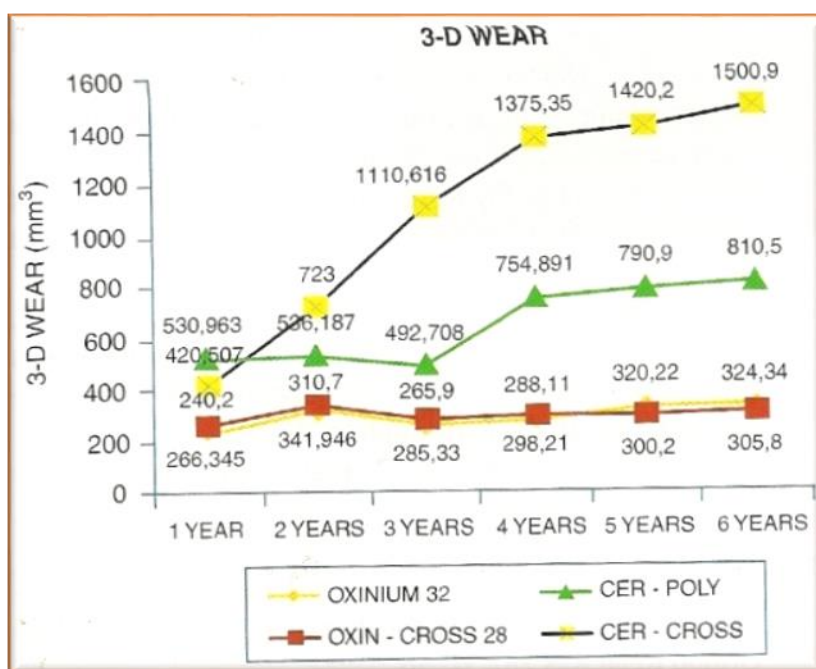
Εικόνα 20. Τρισδιάστατη ανάλυση προϊόντων φθοράς σε συνδυασμούς υλικών αρθρούμενων επιφανειών ένα έως έξι έτη μετεγχειρητικά (Malizos et all, EFORT).
