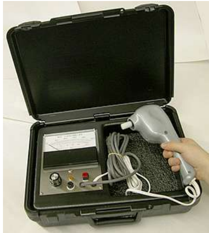
Εικόνα 8. Biothesiometer: φορητή συσκευή μέτρησης του ουδού αισθητικότητας των δονήσεων.
