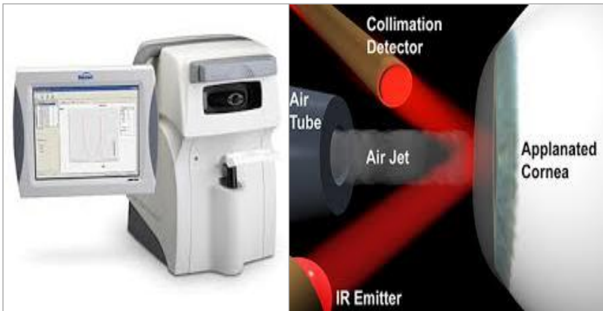
Εικόνα 16: (Αριστερά) ‘Ocular Response Analyzer’ (ORA), (Δεξιά) Σχηματική απεικόνιση του τρόπου λειτουργίας του ORA. 55
