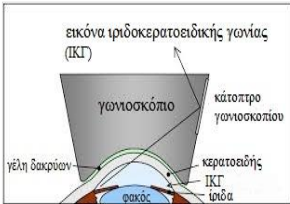
Εικόνα 6: Σχηματική απεικόνιση έμμεσου γωνιοσκοπίου (με κάτοπτρο). (Τροποποιημένη από την βιβλιογραφία) 41
