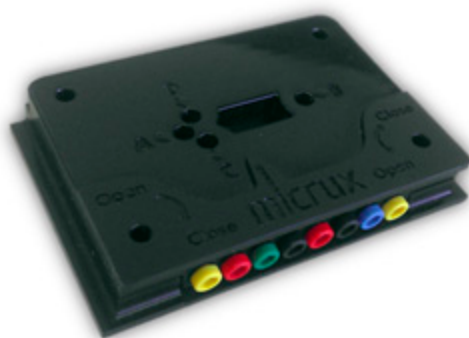
Εικόνα 6.11: Η πλατφόρμα υποδοχής των μικρορευστονικών διατάξεων που παρέχει συγχρόνως τις απαραίτητες ηλεκτρικές επαφές για τη διασύνδεση με τον ποτενιοστάτη και τη γεννήτρια υψηλής τάσης.
