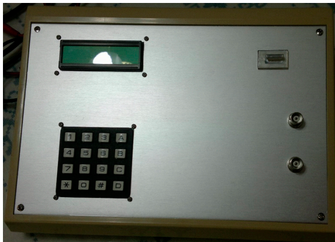
Εικόνα 5.1: Φωτογραφία πρώτης έκδοσης ποτενσιοστάτη.
