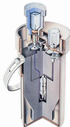
Εικόνα 4.2.: Γεννήτρια ^{99}\text{Mo}/^{99\text{m}}\text{Tc} που αποτελείται από χρωματογραφική στήλη ιονανταλλαγής με υλικό πλήρωσης αλουμίνα ( \text{Al}_2\text{O}_3 )
