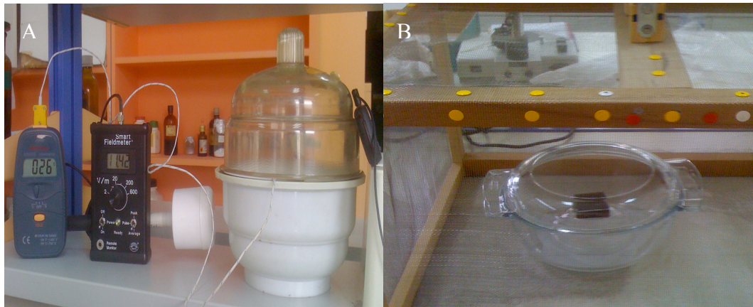
Εικόνα 2.7 Α) έκθεση των απομονωμένων ωοθυλακίων στο μακρινό πεδίο της κεραίας του κινητού τηλεφώνου και καταμέτρηση της έντασης της ακτινοβολίας και της θερμοκρασίας. Β) Τοποθέτηση της ομάδας μάρτυρα εντός κλωβού Faraday, για την προστασία των ωοθυλακίων από την ακτινοβολία.
