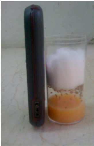
Εικόνα 2.6. Φωτογραφία τρόπου έκθεσης των εντόμων στο εγγύς πεδίο της κεραίας του κινητού τηλεφώνου. Η οπίσθια όψη της συσκευής έρχεται σε επαφή με το σωλήνα της εκτεθειμένης ομάδας, ενώ τα έντομα περιορίζονται με τη βοήθεια πώματος σε έναν μικρό χώρο για την περισσότερο εντοπισμένη και ομοιόμορφη έκθεση στο πεδίο.
