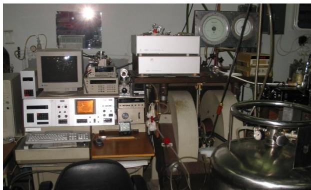
Εικόνα 3. Το EPR φασματοφωτόμετρο Bruker ER200D-SRC του ινστιτούτου επιστήμης υλικών του ΕΚΕΦΕ Δημόκριτος
