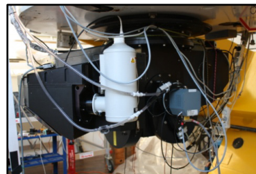
Εικόνα 2.12. Το τηλεσκόπιο διαμέτρου 1.3 m (αριστερά), ο θόλος που το περικλείει (μέση) και ο φασματογράφος φράγματος τοποθετημένος επάνω στο τηλεσκόπιο (δεξιά), όπου διακρίνεται η λευκή φιάλη υγρού αζώτου, η οποία χρησιμοποιείται για την ψύξη της CCD κάμερας.
