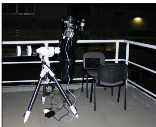
Εικόνα 2.8. Τα νευτώνεια κατοπτρικά τηλεσκόπια διαμέτρου 20 cm (αριστερά) και 25 cm (δεξιά) επάνω σε ρομποτική γερμανική ισημερινή στήριξη στην ταράτσα του πανεπιστημιακού αστεροσκοπείου. Στα τηλεσκόπια έχει προσαρμοστεί η CCD ST-8XMEI, ενώ, επιπροσθέτως, στο τηλεσκόπιο των 25 cm έχει τοποθετηθεί παράλληλα ένα διοπτρικό τηλεσκόπιο διαμέτρου 8 cm με μια χαμηλότερης ποιότητας CCD για αυτόματη οδήγηση του κυρίως οργάνου.
