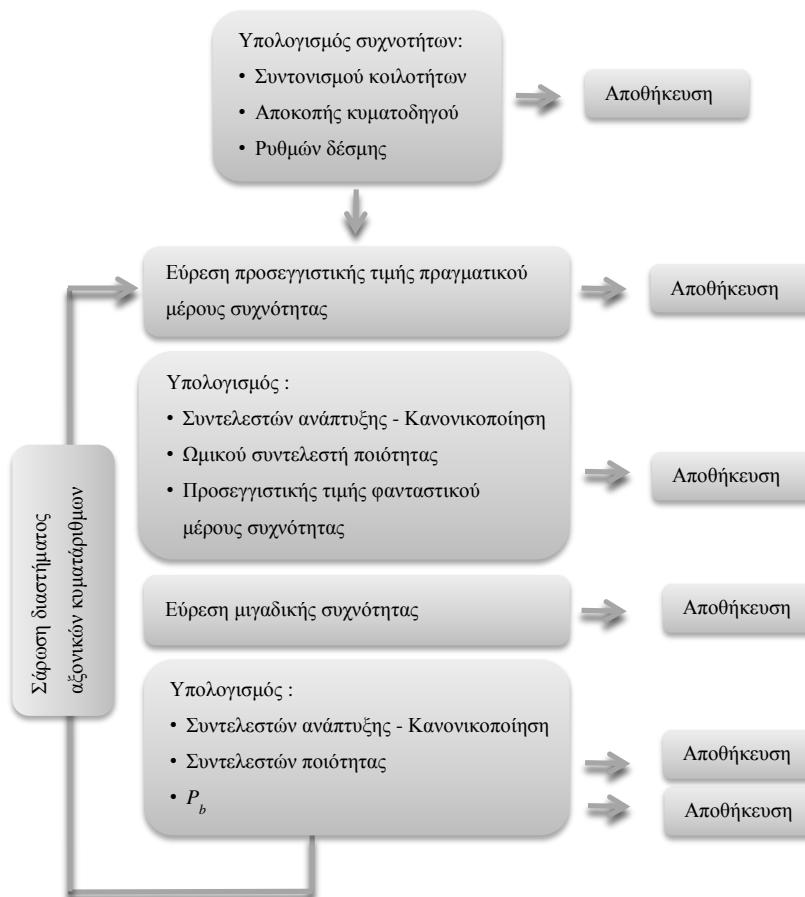
Σχήμα 4.3: Δομή αριθμητικού κώδικα για τον υπολογισμό της σχέσης διασποράς (Τύπος I).
