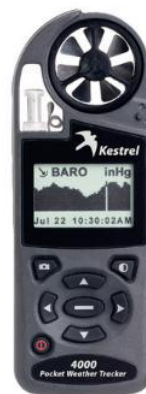
Εικόνα 3.11: Φορητός μετεωρολογικός σταθμός χειρός KESTREL 4000.
