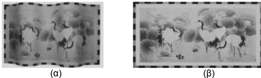
Σχήμα 2.28: (α) Παραμορφωμένη εικόνα (β) διορθωμένη εικόνα μετά την εφαρμογή της μεθόδου [54] η οποία διορθώνει και τα προβλήματα της φωτεινότητας.
