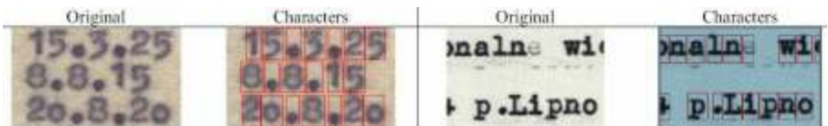
Σχήμα 2.39: Κατάτμηση χαρακτήρων με χρήση προβολών σύμφωνα με τη μέθοδο [73].
