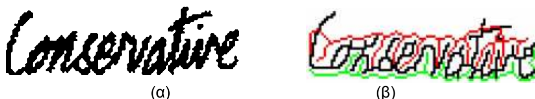
Σχήμα 2.46: Εξαγωγή σκελετού σύμφωνα με τη μέθοδο [90]: (α) Αρχική λέξη, (β) σκελετός της λέξης (μαύρος) και σκελετός του υπόβαθρου στο πάνω (κόκκινος) και κάτω (πράσινος) τμήμα της λέξης.
