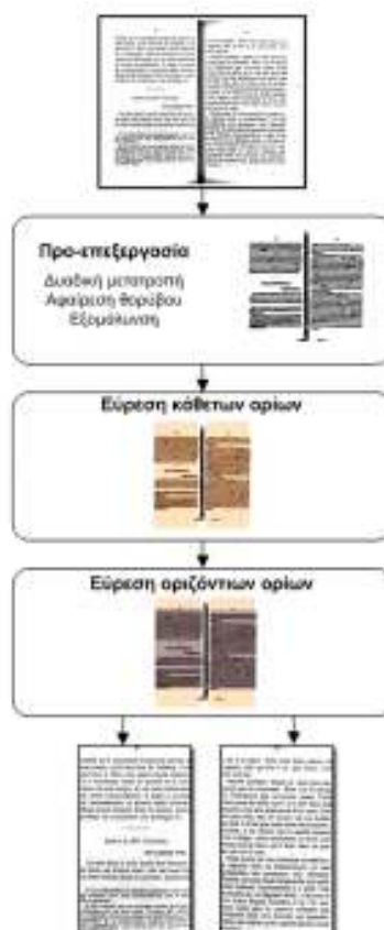
Σχήμα 3.7: Διάγραμμα ροής προτεινόμενης μεθόδου για τον εντοπισμό και την αφαίρεση του περιθωρίου καθώς και τον διαχωρισμό των διπλών σελίδων.
