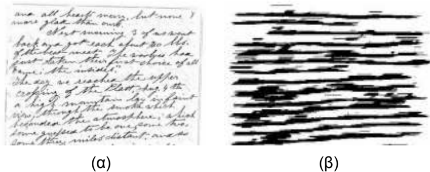
Σχήμα 2.32: (α) Ιστορικό χειρόγραφο έγγραφο, (β) αποτέλεσμα μετά την εφαρμογή του πίνακα μεταβάσεων σύμφωνα με τη μέθοδο [71].
