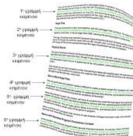
Σχήμα 4.14: Παράδειγμα επιλογής έξι αντιπροσωπευτικών γραμμών κειμένου σε ένα παραμορφωμένο έγγραφο.
