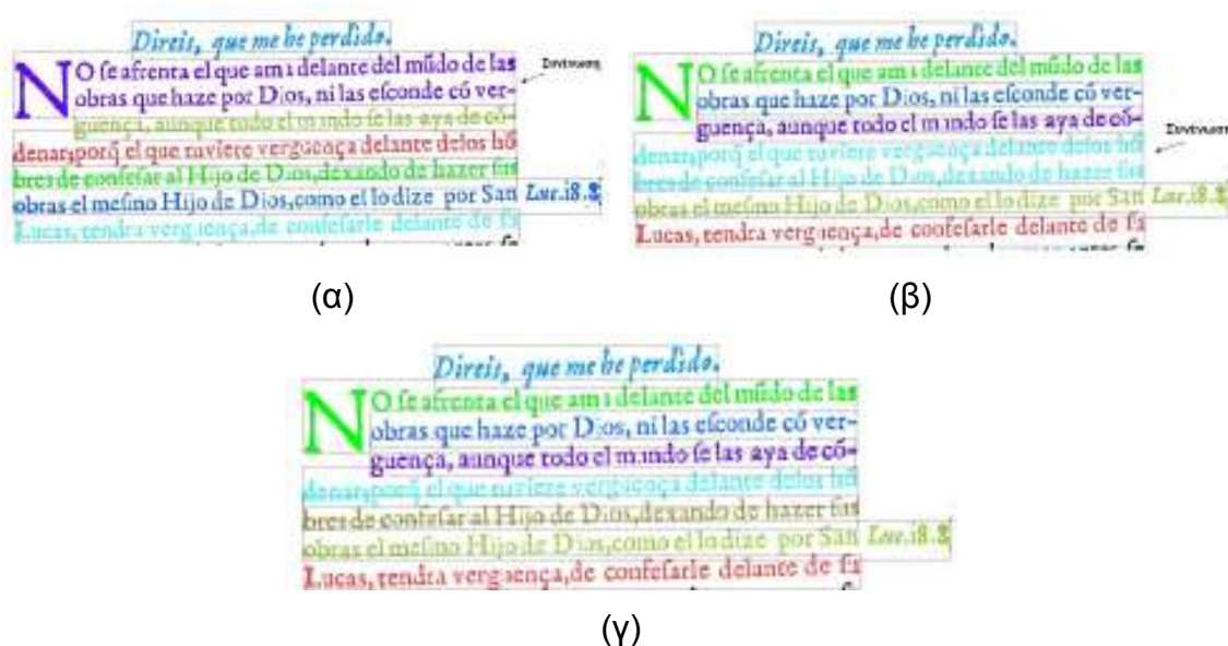
Σχήμα 5.12: Αποτελέσματα κατάτμησης ιστορικής εικόνας εγγράφου με τη χρήση της μεθόδου (α) ανάλυσης προβολών [77], (β) adaptive RLSA [115] και (γ) μετά τον συνδυασμό τους.
