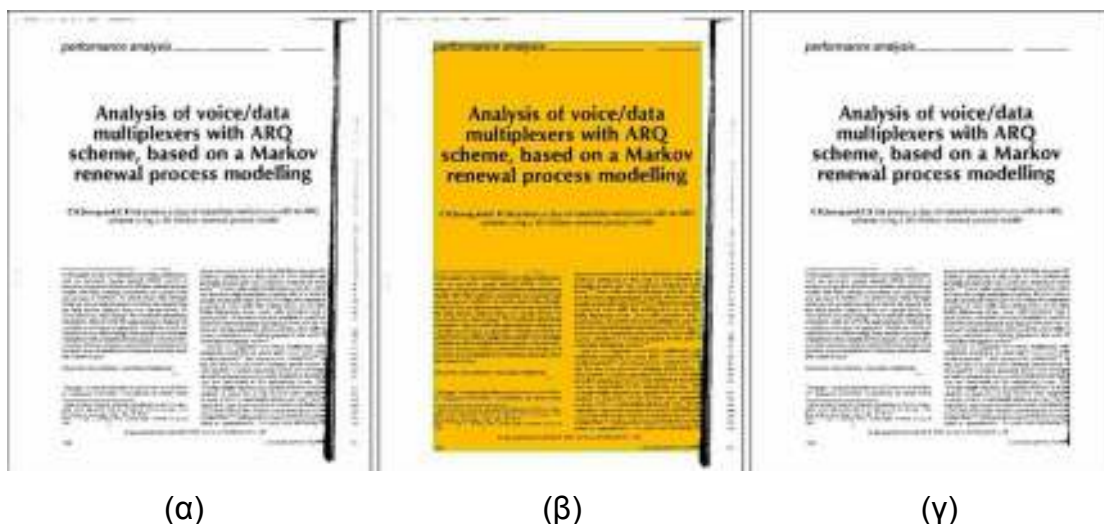
Σχήμα 2.10: Παράδειγμα εφαρμογής της μεθόδου [24] για την αφαίρεση του περιθωρίου: (α) Αρχικό έγγραφο όπου παρατηρείτε επικάλυψη του κειμένου από το περιθωρίου, (β) εντοπισμός του πλαισίου της περιοχής κειμένου, (γ) τελικό αποτέλεσμα μετά την αφαίρεση του περιθωρίου.
