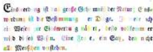
Σχήμα 7.7: Κατάτμηση χαρακτήρων σε τυπωμένο ιστορικό έγγραφο σύμφωνα με την προτεινόμενη μέθοδο.
