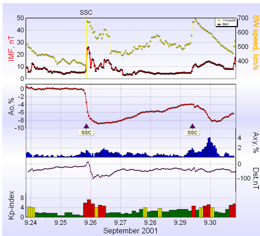
Σχ. 6.10 Μεταβολές του διαπλανητικού μαγνητικού πεδίου και της ταχύτητας του ηλιακού ανέμου (άνω διάγραμμα), της έντασης της κοσμικής ακτινοβολίας A_0 και της ανισοτροπίας A_{xy} (μεσαίο διάγραμμα) και των δεικτών Dst και K_p (κάτω διάγραμμα) για το γεγονός της 25 ης Σεπτεμβρίου 2001.
