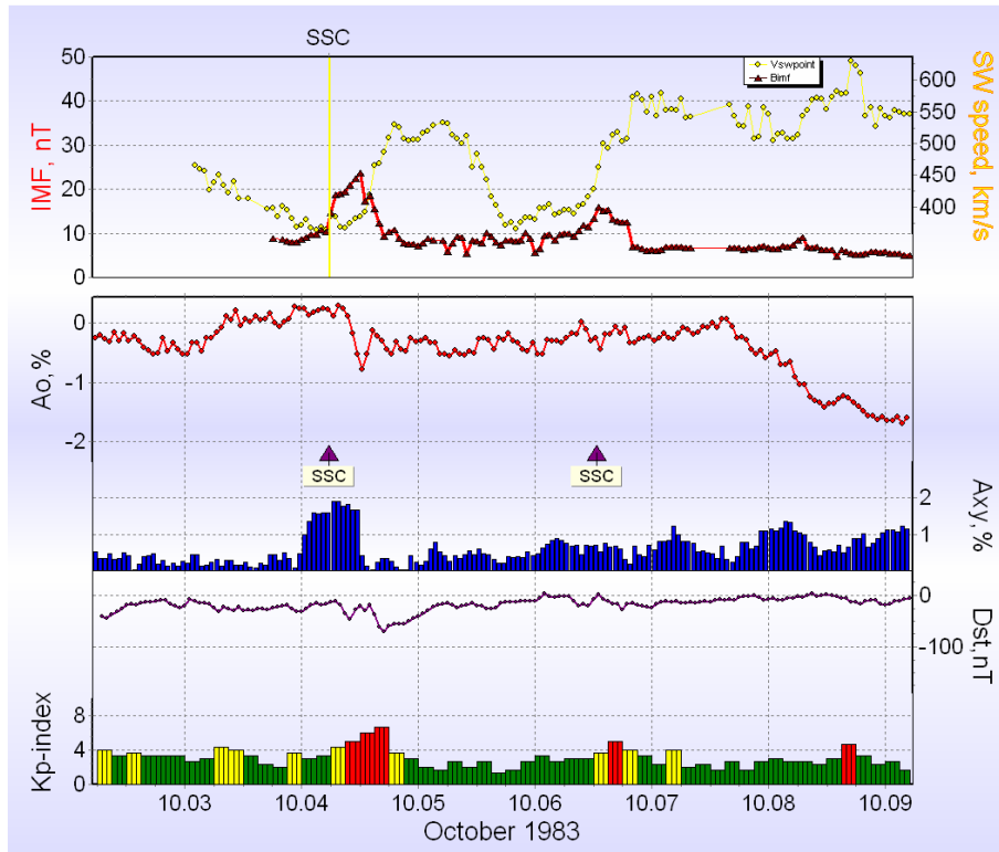
Σχ. 6.23 Μεταβολές του διαπλανητικού μαγνητικού πεδίου και της ταχύτητας του ηλιακού ανέμου (άνω διάγραμμα), της έντασης της κοσμικής ακτινοβολίας A_0 και της ανισοτροπίας A_{xy} (μεσαίο διάγραμμα) και των δεικτών Dst και Kp (κάτω διάγραμμα) για το γεγονός της 4 ης Οκτωβρίου 1983.
