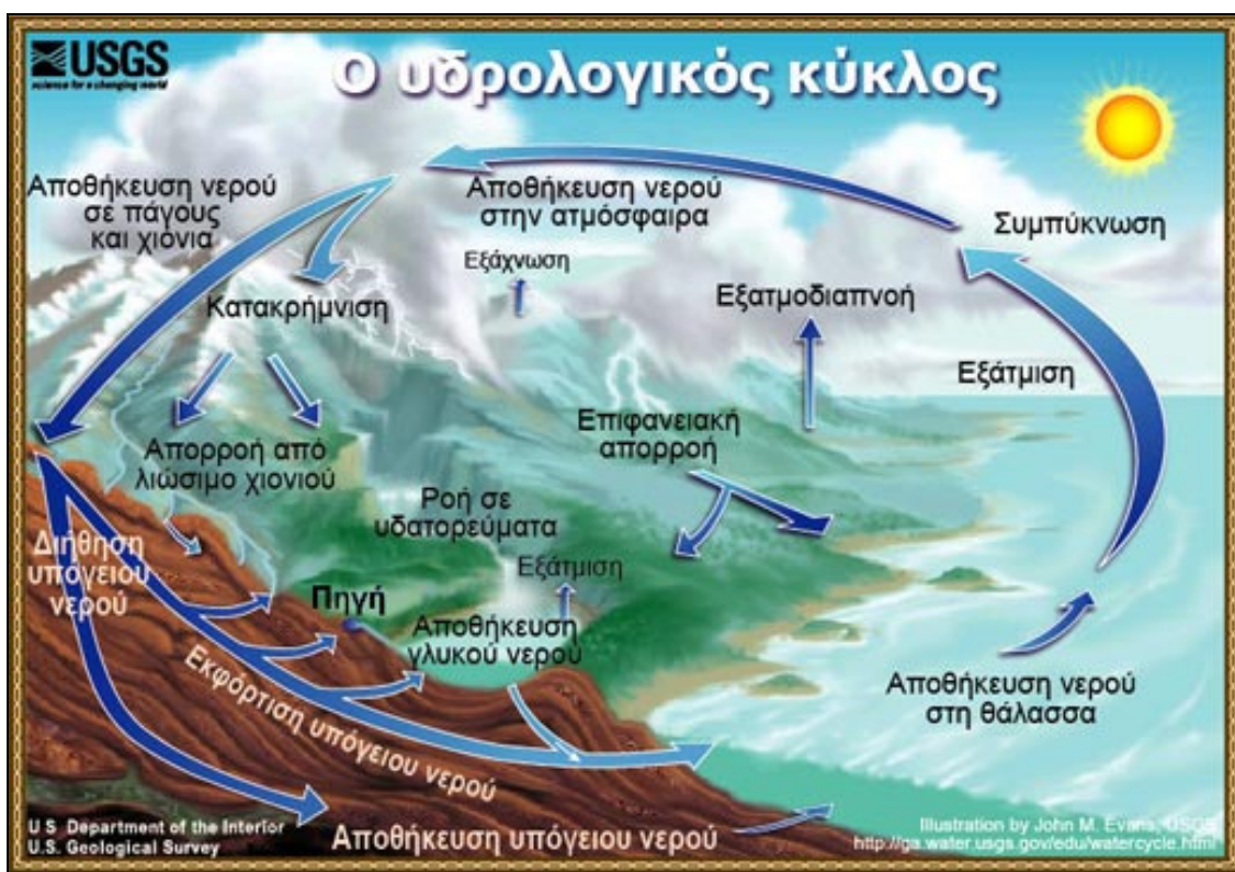
Σχήμα 1.2: Σχηματική αναπαράσταση του υδρολογικού κύκλου ( http://ga.water.usgs.gov )
