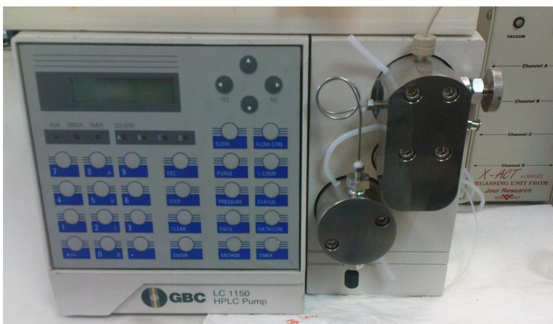
Εικόνα 21. Λεπτομέρεια της αντλίας GBC-LC1150 (Εργαστήριο Φαρμακολογίας).
