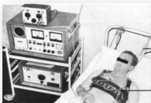
Εικόνα 20: «Bloc Réanimateur», ο πρώτος αυτόματος εξωτερικός απινιδιστής, σχεδιάστηκε από τον Fred Zacouto. ( http://circ.ahajournals.org/ )
