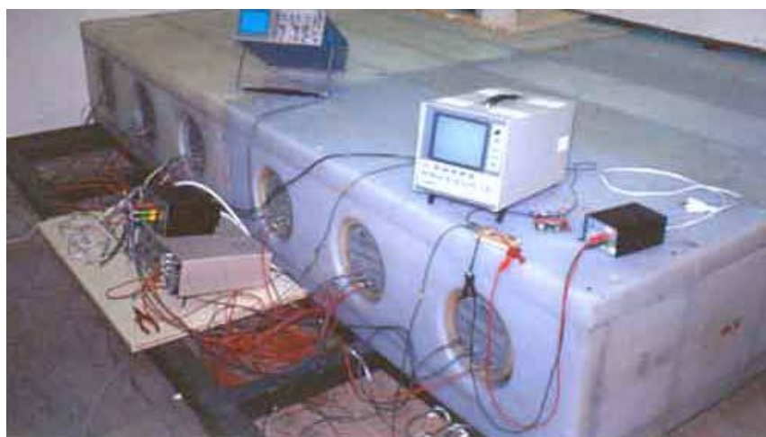
Εικόνα 3.31: Η ανιχνευτική διάταξη & συνδεσμολογία του μετρητή νετρονίων του σταθμού κοσμικής ακτινοβολίας του Πανεπιστημίου της Αθήνας.
