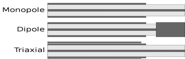
Κεραίες με γραμμοειδές στοιχείο εκπομπής( μονοπολική, διπολική, τριαξονική.)
