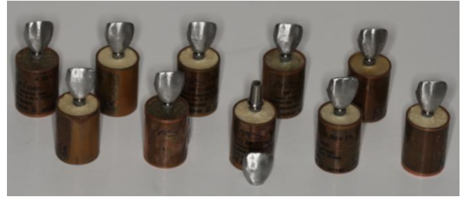
Εικόνα 35-36: Οι μεταλλικές στεφάνες των δύο ομάδων δοκιμίων, μετά την τελική στίβωσή τους και πριν τη συγκόλλησή τους με τη χρήση ρητινώδους κονίας διπλού πολυμερισμού.
