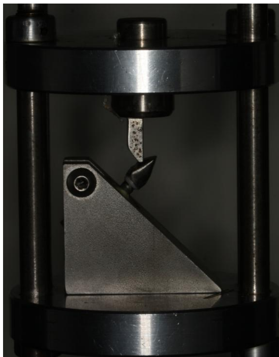
Εικόνα 41: Το δοκίμιο κατά την τοποθέτησή του στην ειδική συσκευή μηχανικών δοκιμασιών Tensometer 10, πριν την έναρξη της διαδικασίας στατικής φόρτισής του.
