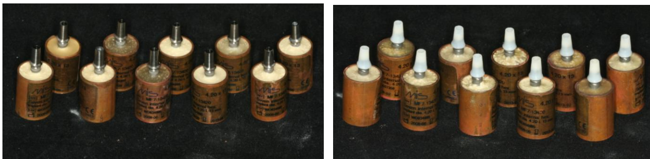
Εικόνα 30-31: Οι δύο ομάδες δοκιμίων, μετά τη συγκόλληση των κεραμικών καλυπτρών διπυριτικού λιθίου, πριν την κατασκευή των στεφανών. Αριστερά, διακρίνεται η ομάδα I (control group) με τα μηχανικά στηρίγματα τιτανίου και δεξιά, η ομάδα II (test group) με τα υβριδικά μηχανικά στηρίγματα.
