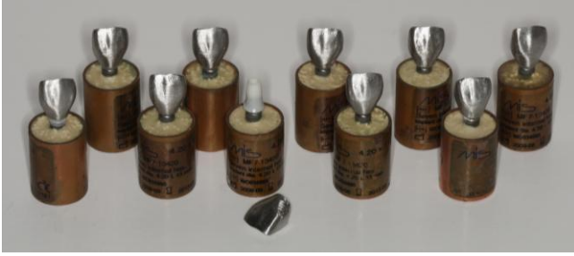
Εικόνα 35-36: Οι μεταλλικές στεφάνες των δύο ομάδων δοκιμίων, μετά την τελική στίβωσή τους και πριν τη συγκόλλησή τους με τη χρήση ρητινώδους κονίας διπλού πολυμερισμού.
